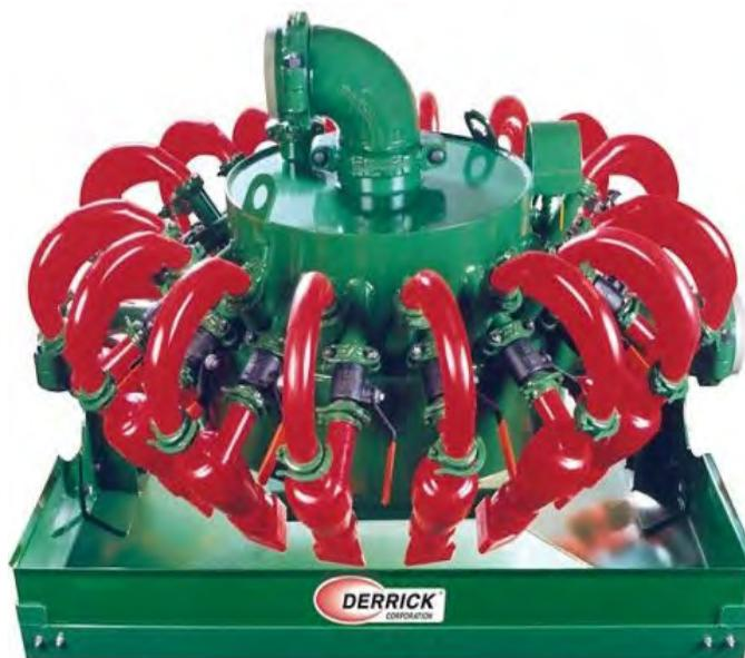
Рис. 2.12. Круговой илоотделитель фирмы «DERRICK»
