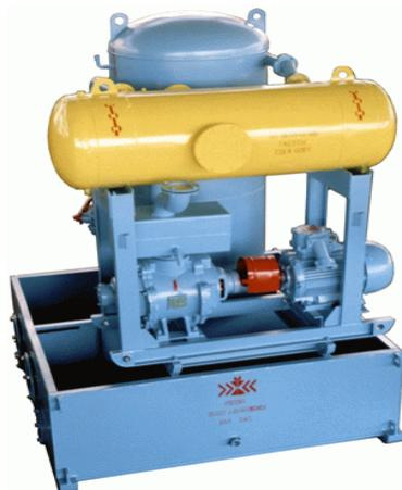
Рис. 2.15. Дегазатор бурового раствора Каскад-40-03
