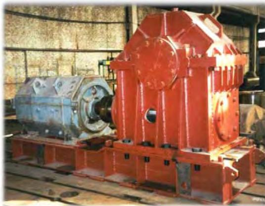
Рис. 2.17. Регулятор подачи долота (РПДЭ)
