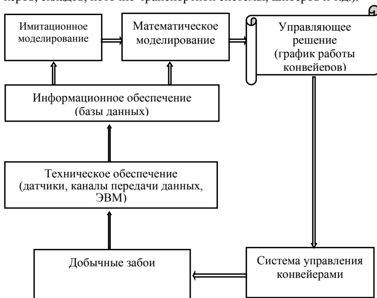
Рис. 1 – Структурная схема организации оперативного учёта добычи и прогноза качества руды при управлении горными работами калийного рудника
