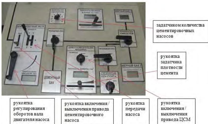
Рис. 1.15. Горизонтальная панель пульта управления цементированием
