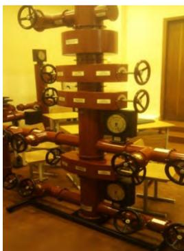
Рис. 1.10. Пост устьевого оборудования
