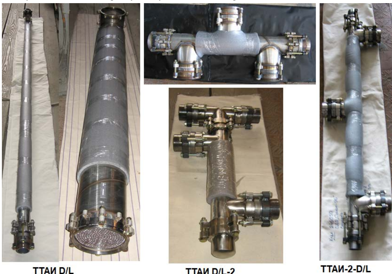
Рисунок 3 – Примеры выводов патрубков различных моделей ТТАИ
