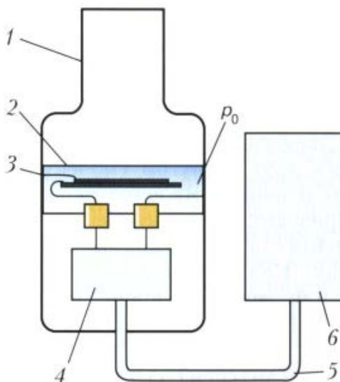
Рисунок 3 – Мембранно-емкостной вакуумметр: 1– корпус; 2 – мембрана; 3 – пластина конденсатора; 4 – вторичный преобразователь; 5– соединительный кабель; 6 – блок питания и отсчетное устройство;  $p_0$  – опорное давление
