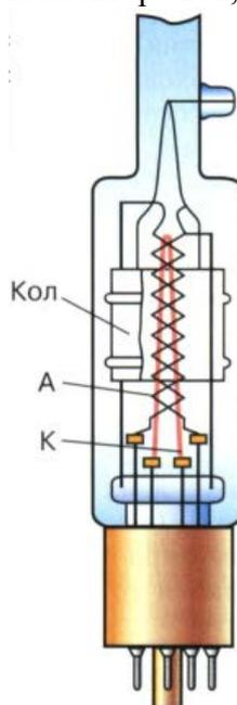
Рисунок 4 – Электронный ионизационный вакуумметр:
