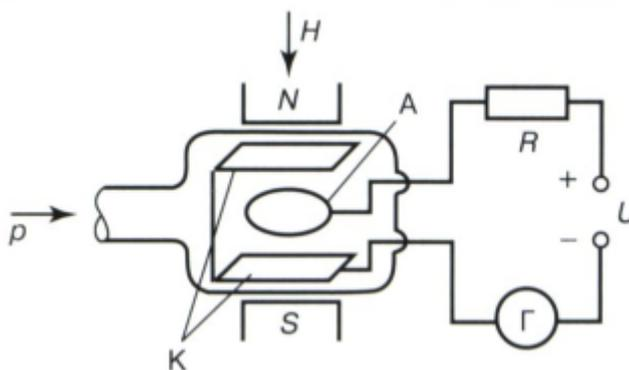
Рисунок 5 – Схема магнитного электроразрядного вакуумметра: А – анод; К – катод; Г – гальванометр; Н – напряженность магнитного поля; U – напряжение между электродами; R – резистор; p – давление; N и S – северный и южный полюсы магнита [3]
