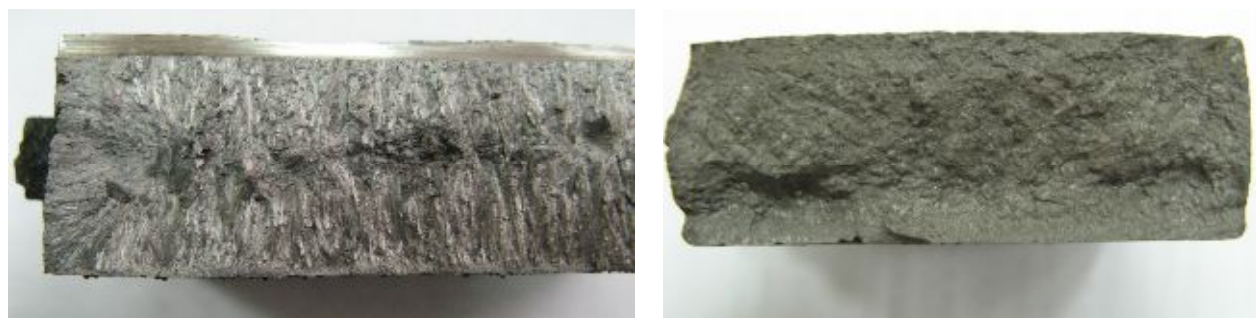
а – исходная, б – модифицированная Al + BiMo(катализатор) + SiCa Рисунок 2 – Макроструктура изломов образцов
