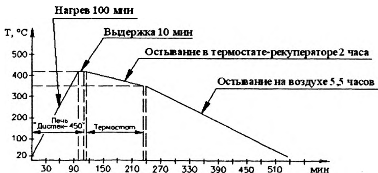
Рисунок 3 – Режим ТДЦ с использованием термостата-рекуператора для реторты после цикла нагрев–охлаждение
