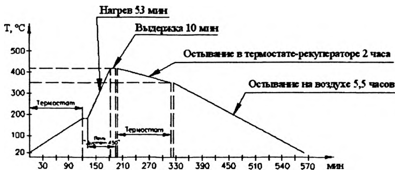
Рисунок 4 – Режим ТДЦ с учетом помещения реторты в термостат-рекуператор перед и после процесса ТДЦ
