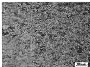
Рисунок 5 – Микроструктура поперечного сечения покрытия из стали 08X19H9T (шлиф не травлен)
