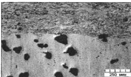
Рисунок 4 – Поперечный шлиф образца из ВЧШГ (нижняя часть) с покрытием из стали 08Х19Н9Т (образец не травлен)
