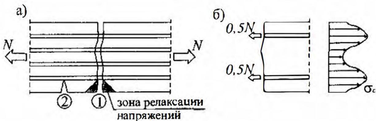
Рис. 3.3. Зона релаксации напряжений в защитном слое бетона (а) и неравномерное распределение напряжений в бетоне (б) при рассредоточенном армировании
