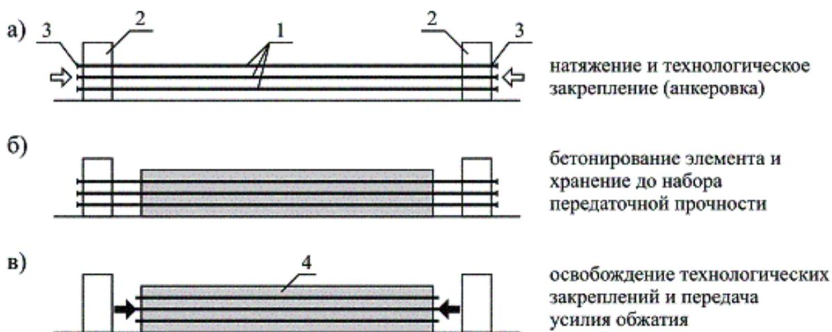
Рис. 1.12. Последовательности технологических операций при предварительном напряжении арматуры на упоры
