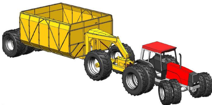
Рис. 1 – Приводной прицеп для перевозки торфа
