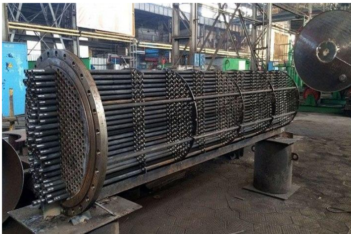
Рис. 2 – Кожухотрубный теплообменник (в процессе сборки)
