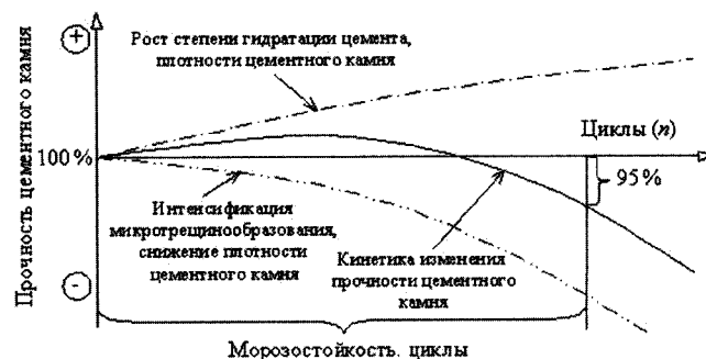
Рис. 2. Зависимость структурных и физико-механических характеристик цементного камня от количества циклов замораживания и оттаивания n
