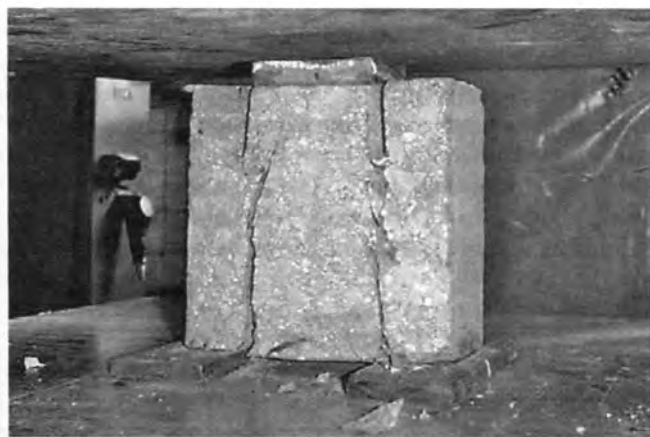
Рис. 6. Разрушение бетонного образца при испытании на поперечный сдвиг
