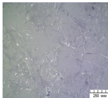
Рисунок 8 – Микроструктура оксидного стекла системы \text{Na}_2\text{O-K}_2\text{O-ZnO-P}_2\text{O}_5 после нагрева при 975 K в течение 4 часов. Прекурсор – оксид-гидроксидное стекло с 5 мас. % химически связанной \text{H}_2\text{O} , нагрев при 640 K
