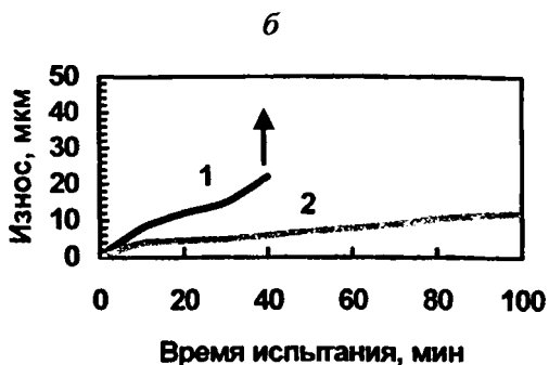
Рис. 5. Кривые Лоренса для стали 4Х5МФС: a – Carbo 1; б – Carbo 2; 1 – уд. нагр. – 400 МПа; 2 – уд. нагр. – 50 МПа
