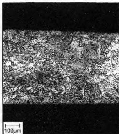
Рис. 1. Влияние содержания серы в расплаве на микроструктуру феррита: а – содержание серы – 0,04 %; б – содержание серы – 0,01 %
