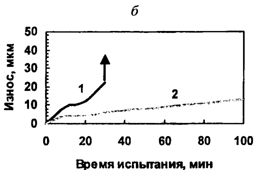
Рис. 3. Кривые Лоренса для стали X12: а – Carbo 1; б – Carbo 2; 1 – уд. нагр. – 400 МПа; 2 – уд. нагр. – 50 МПа
