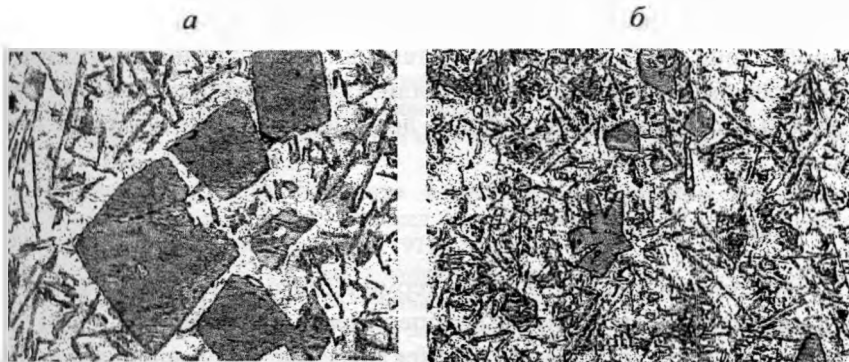
Рис. 6. Микроструктура сплава Al – 16 % Si после выдержки в печи при температуре 870 °С: а – центральная часть образца ( \times 250 ); б – периферийная часть образца ( \times 125 )
