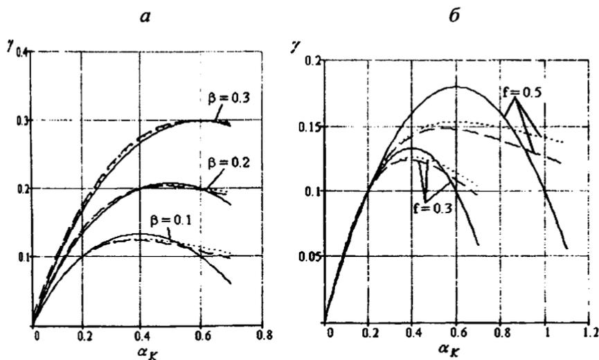
Рис. 2. Изменение мгновенного критического угла при прокатке с нарастающим обжатием в зависимости: а – от угла касания  $\alpha_K$  и угла  $\beta$ , определяющего положение сечения выхода при коэффициенте трения  $f = 0,3$  и  $R/h = 10$ ; б – от угла касания  $\alpha_K$  и коэффициента трения  $f$  при  $R/h = 10$  и  $\beta = 0,1$  по формулам (15) (----), (16) (—) и по данным [3] (.....)
