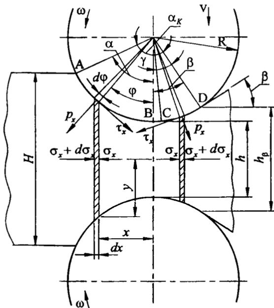
Рис. 1. Схема действия сил в очаге деформации при прокатке с нарастающим обжатием
