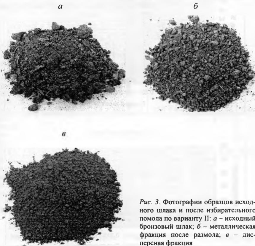
Рис. 3. Фотографии образцов исходного шлака и после избирательного помола по варианту II: а – исходный бронзовый шлак; б – металлическая фракция после размола; в – дисперсная фракция
