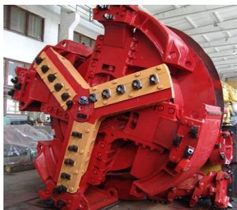
Рис. 1 – Расположение зубков на лучах центрального ротора КРП-3
