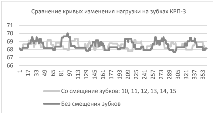
Рис. 3 – Диаграммы распределения суммарных моментов сопротивления разрушению горной породы зубками центрального ротора в пределах его одного оборота
