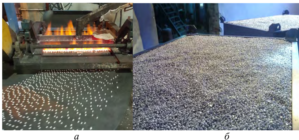
Рисунок 2 – Завершающая стадия получения «сухих» гранул (а) и алюминиевые гранулы, готовые к отгрузке (б)
