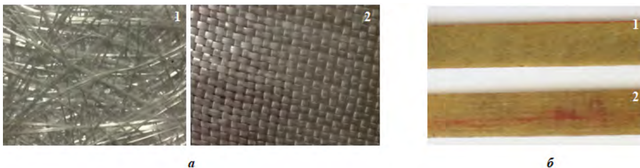
1а – стекломат, 2а – стеклорогожа, 1б – стеклотекстолит, армированный стекломатом, 2б – стеклотекстолит, армированный стеклорогожей
