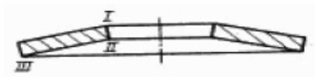
Рис. 2. Напряженные кромки тарельчатой пружины
