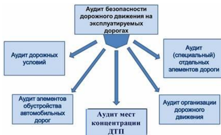
Рисунок 2 - Виды аудита БДД на эксплуатируемых дорогах и их объекты проверки
