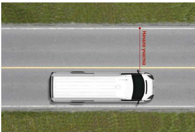
Рис. 2.4. Положение лаборатории в начале и конце измерительного участка
