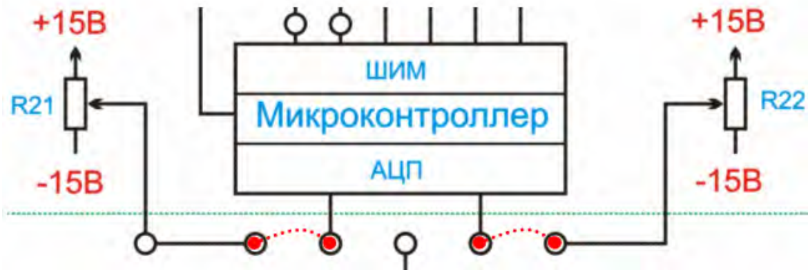
Рисунок 8.5 – Схема подключения задания для ШИП
