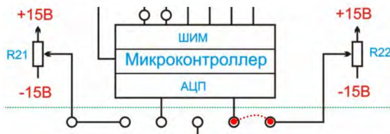
Рисунок 4.10 – Схема подключения напряжения задания для ШИП обмотки возбуждения
