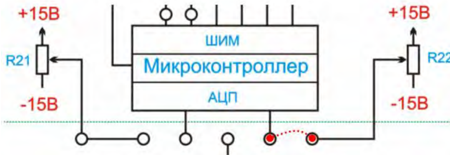
Рисунок 2.9 – Схема подключения напряжения задания для ШИП обмотки возбуждения
