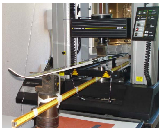
Рис. 4. Размещение спортивной лыжи при испытании на изгиб
