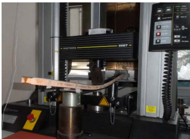
Рис. 6. Измерение прогиба трехслойного ПЭ-С-П образца от усилия, примененного в центре при верхнем положении антифрикционного слоя полиэтилена
