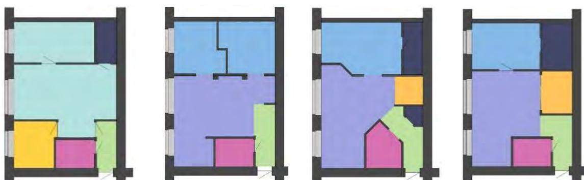
Рис.4. Существующая планировка и варианты перепланировки двухкомнатной квартиры
