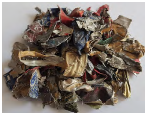
Рисунок 1 – Образцы отходов алюминия 4 сорта класса Г
