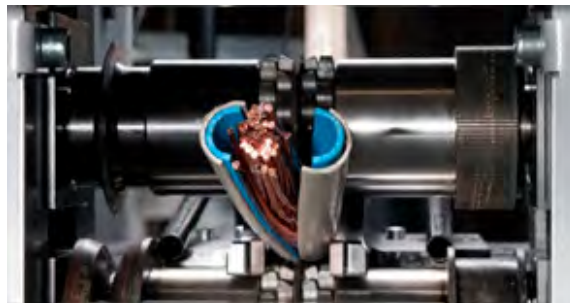
Рисунок 2 - Работа кабелеразделочного станка с дисковыми ножами
