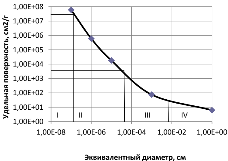
Рисунок 1.1 - Зависимость площади удельной поверхности дисперсной системы от размера частиц [9]: I – молекулярно-дисперсные; II – коллоидные; III – микрогетерогенные; IV - грубодисперсные
