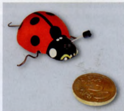
Рис. 1. Автономный ультразвуковой привод, работающий в режиме управляемого резонанса
