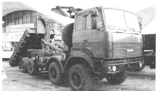
Рис. 4. Тягач МЗКТ-73011, оборудованный системой «мультилифт» МПР-2
