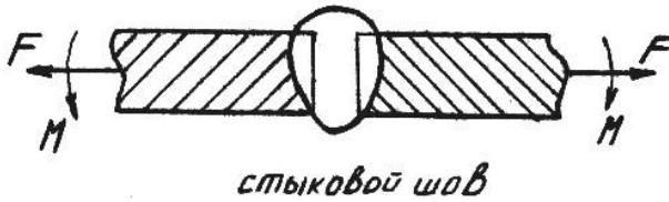
Рис. 26.9. К расчету сварного соединения встык
