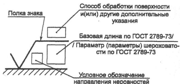
Рис. 1.53. Структура обозначения шероховатости поверхности
