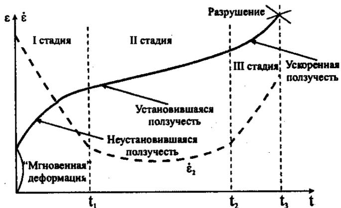
Рис. 6.1. Кривая зависимости деформации от времени (сплошная кривая) для образца, к которому приложена постоянная растягивающая нагрузка при температуре, близкой к температуре плавления вещества, и кривая зависимости скорости ползучести от времени (пунктирная линия при средней температуре испытания)
