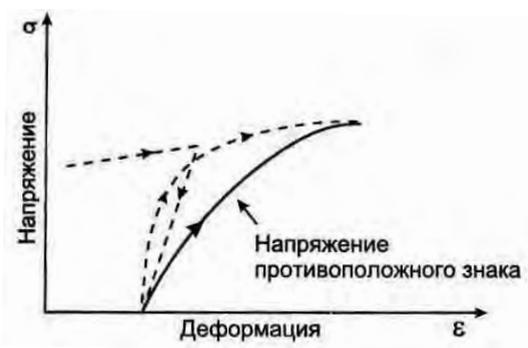
Рис. 3.10. Кривая «напряжение–деформация», иллюстрирующая эффект Баушингера
