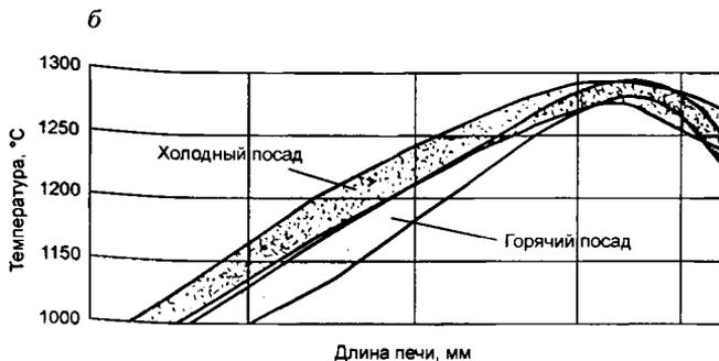
Рис. 1. Схема продольного разреза печи стана 850 БМЗ с шагающими балками (*а*) и рекомендуемое распределение температуры греющих газов вдоль печи (*б*)
