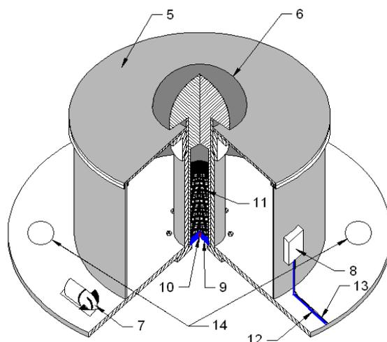
1 – жесткая несущая рама; 2 – сферически корпус; 3 – шахта; 4 - соединительная муфта; 5 - крышка корпуса; 6 – ледобойный снаряд; 7 – двигатели; 8 – блок управления; 9 – полиуретановый пьж; 10 – электроразрядник; 11 – порошок; 12 – воздухопроводом; 13 – кабелем управления и электропитания; 14 – видеокамеры.
