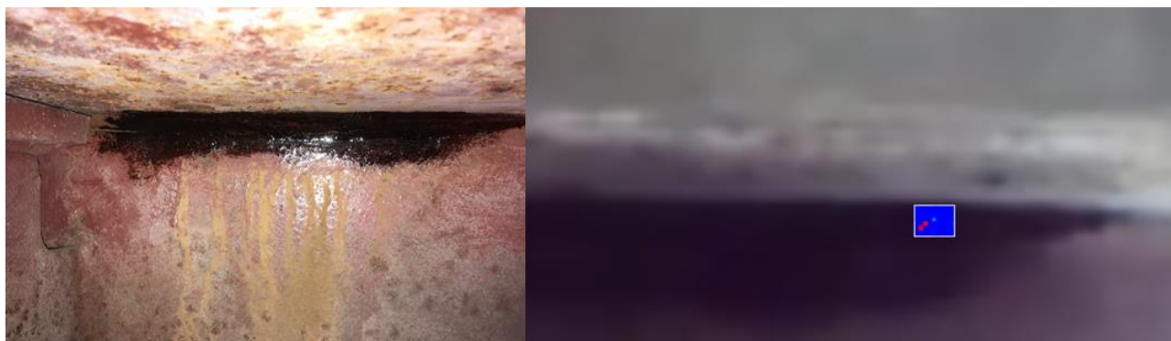
Рисунок 3 – Трещина типа Т-13 и положение её вершины, полученное при обработке термограмм
