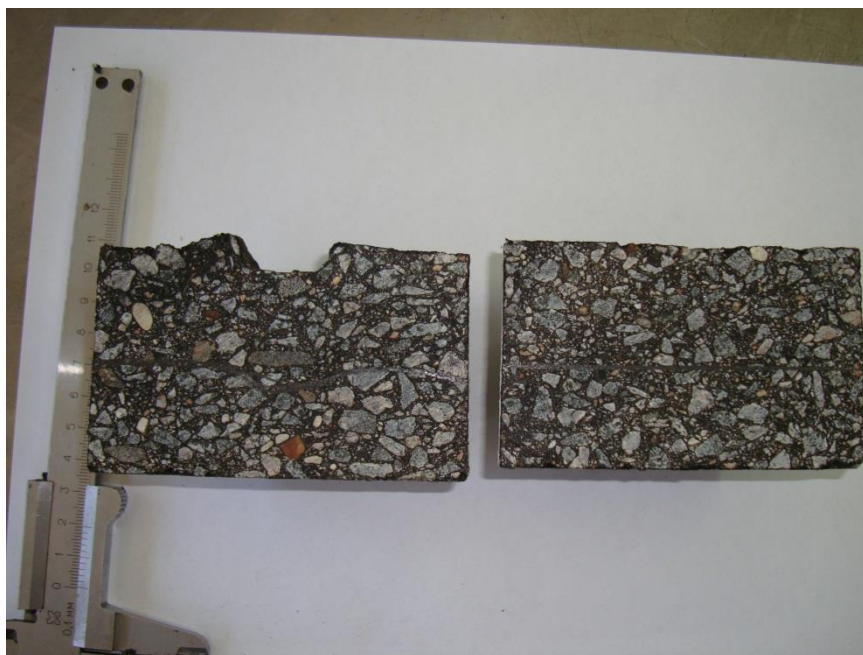
Рисунок 3 – Образцы после испытания на устойчивость к пластическим деформациям: а - образец без армирования; б - образец армированный БСД
