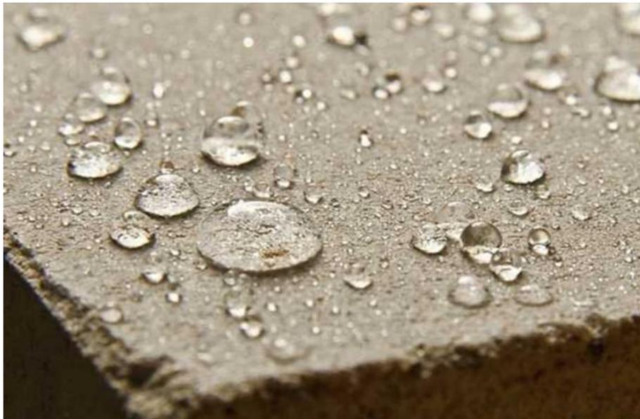
Рисунок 2 – Пример гидрофобизатора
