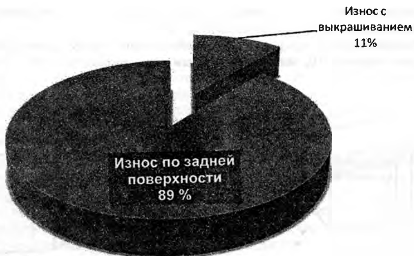
Рис. 3. Диаграмма состояния режущих граней СНП LCMX 06T204-D57 WKP35 борштанги 1012 'Walter' в момент съема со станка. Операция 020. Обрабатываемая деталь 80-1701025-B
