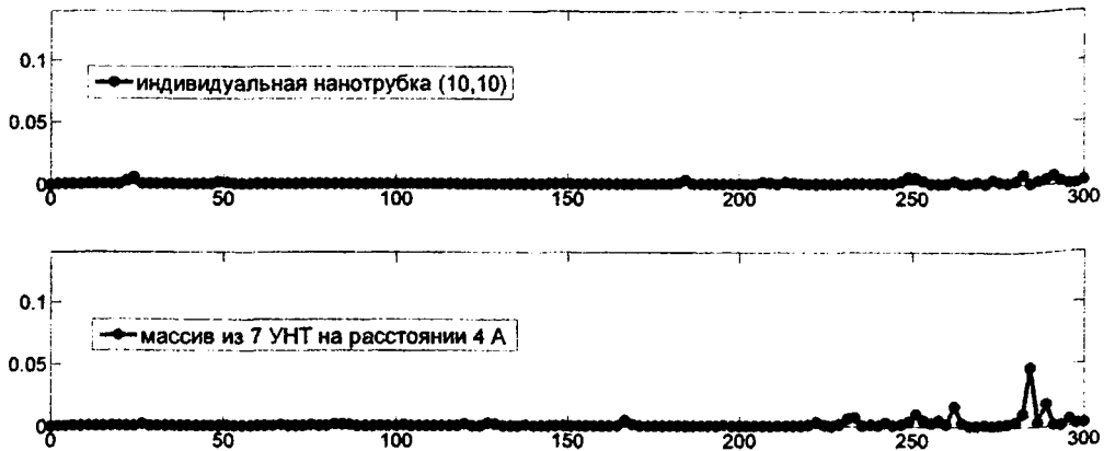
Рис. 3. Спектры поглощения индивидуальной УНТ и массивов УНТ в относительных единицах в низкочастотной области
