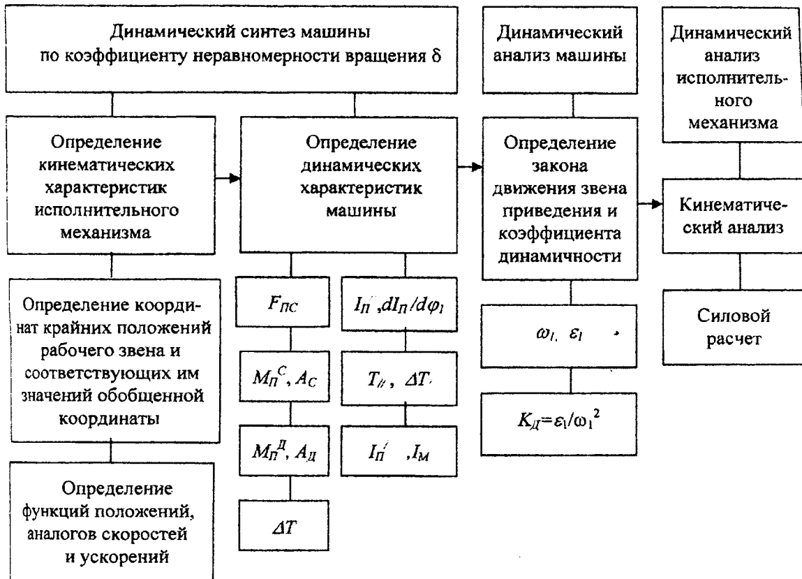
Рис. 1. Блок-схема динамического исследования машинного агрегата
