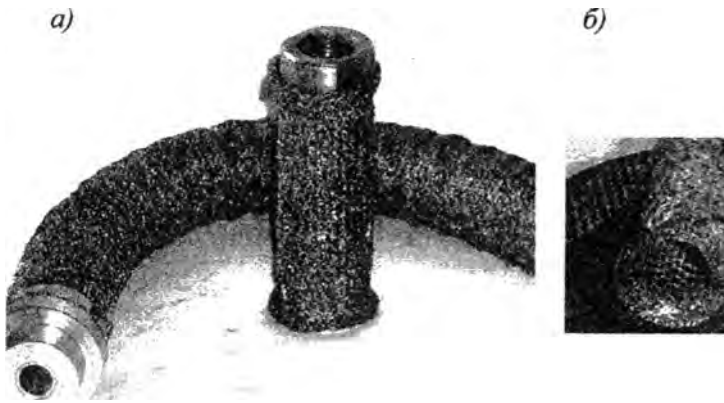
Рис. 2. Армирование ПМНП спиральной пружиной (а) и тканой сеткой (б).
