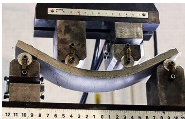
Рисунке 15.7 Самозалечивающийся эластичный бетон
