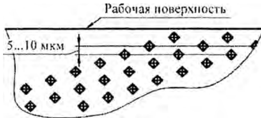
Рис. 1. Схема измерения микротвердости по глубине
