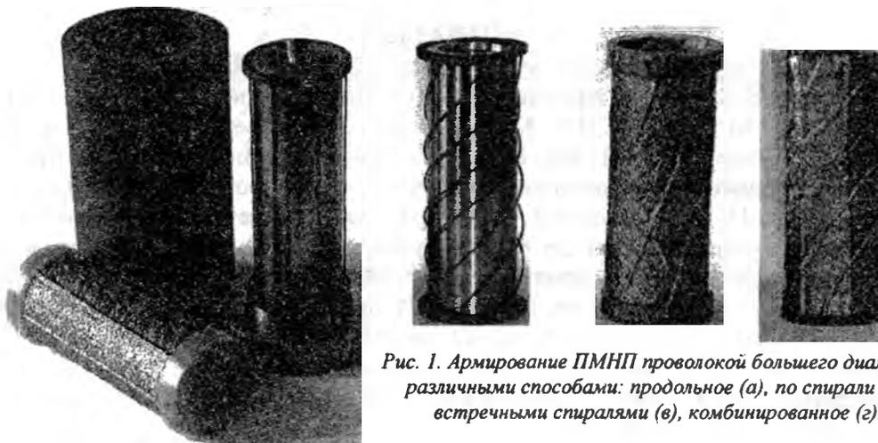
Рис. 1. Армирование ПМНП проволокой большего диаметра различными способами: продольное (а), по спирали (б), встречными спиралями (в), комбинированное (г).
