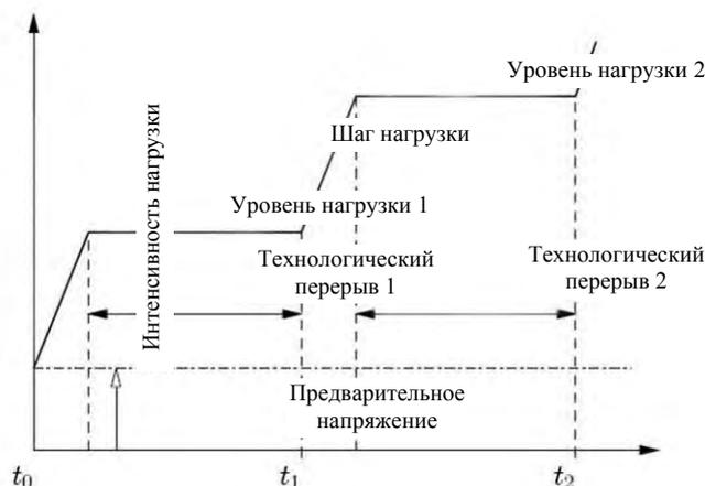
Рисунок 3.21: Хронология отдельного шага нагрузки
