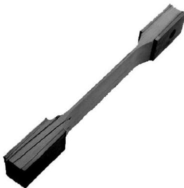
Рисунок 3.6: Разлом в рабочей части образца, использовавшегося при проведении одноосных испытаний
