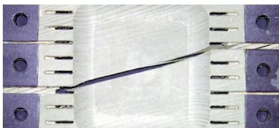
Рисунок 4.11: Продольный излом образца с углом к направлению волокон  $\varphi = 15^\circ$  после двухосного напряжения с коэффициентом  $\kappa = +1:0$
