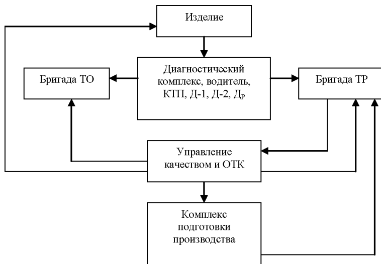
Рис. 5.8. Схема использования диагностирования для оперативного управления ТО и ТР в парке
