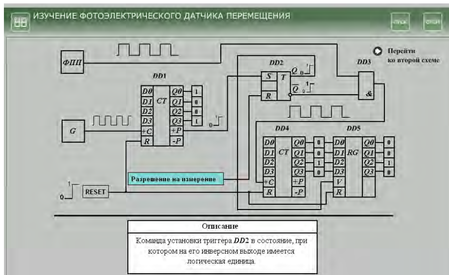
Рис. 7. Скриншот окна со схемой цифрового измерителя скорости
