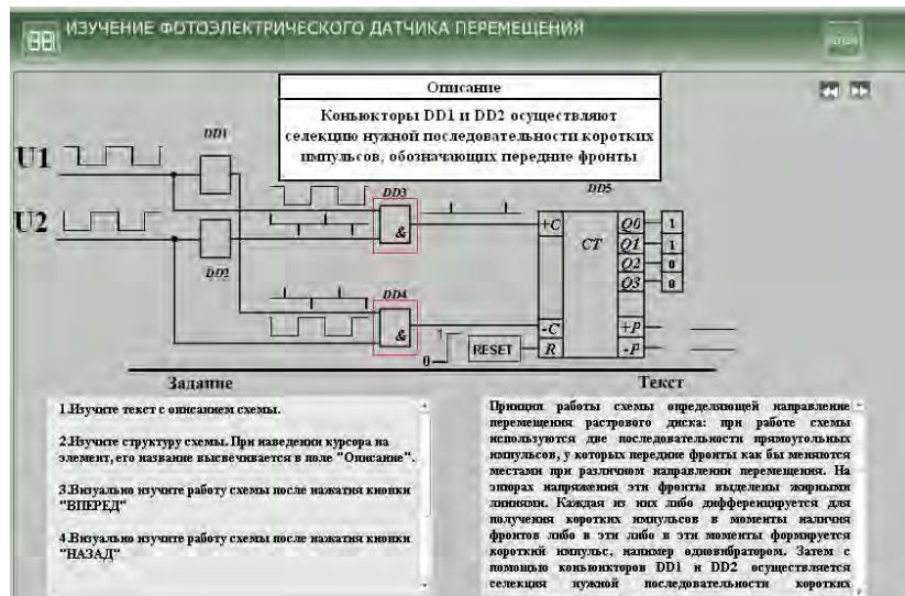
Рис. 6. Скриншот окна со схемой, определяющей направление вращения контролируемого вала
