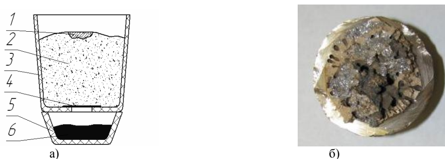
Рисунок 3 – Методика проведения восстановительной плавки а) и образец полученной лигатуры б). 1 – запальная смесь; 2 – исходная смесь; 3 – тигель с отверстием; 4 – алюминиевая пластина; 5 – изложница; 6 – полученная лигатура
