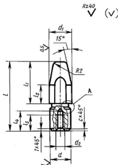
Рис. 3.38. Направляющий штырь с резьбовым отверстием
