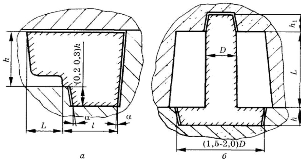
Рис.1.4. Примеры выполнения стержневых знаков:
