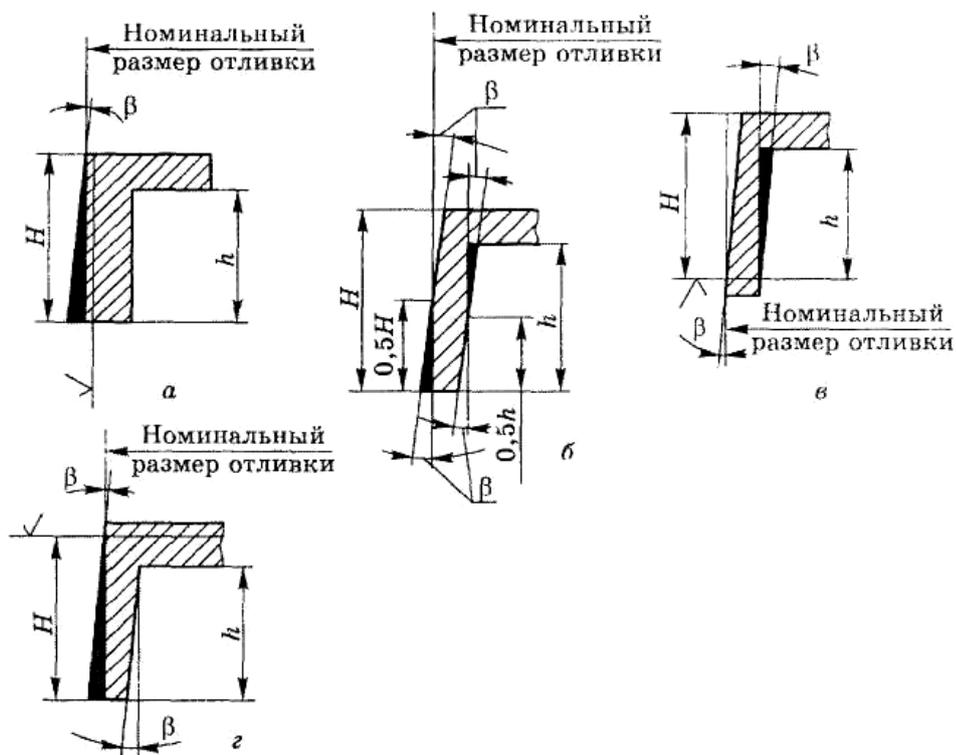
Рис1.2. Формовочные уклоны на рабочих поверхностях моделей:
