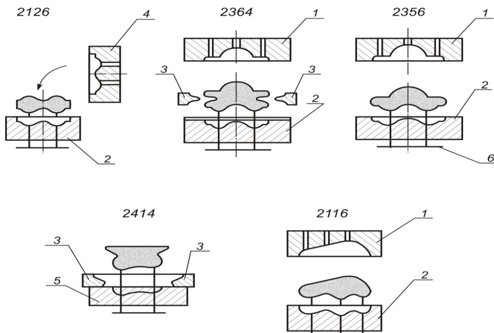
Рис.3.22. Конструктивные схемы стержневых ящиков с наддувом перпендикулярноплоскости разъема:
