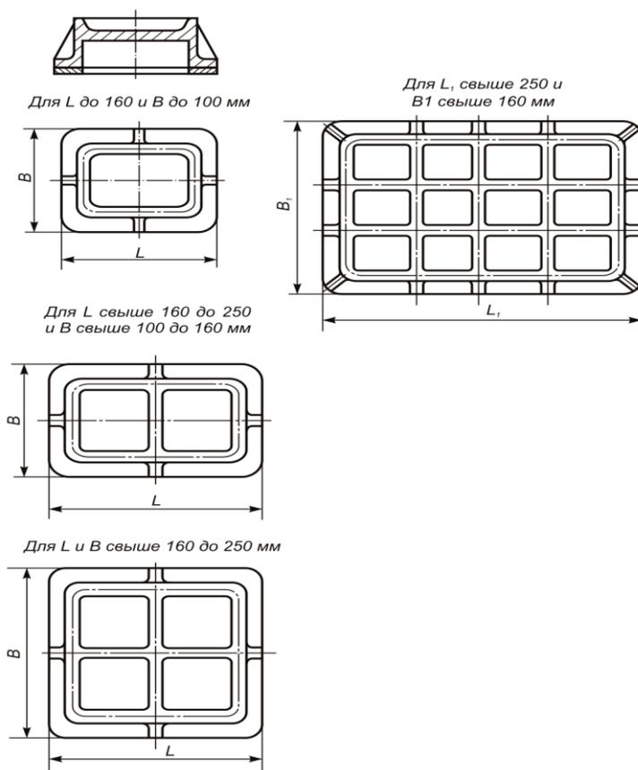
Рис.3.2. Вертикальные ребра прямоугольных стержневых ящиков
