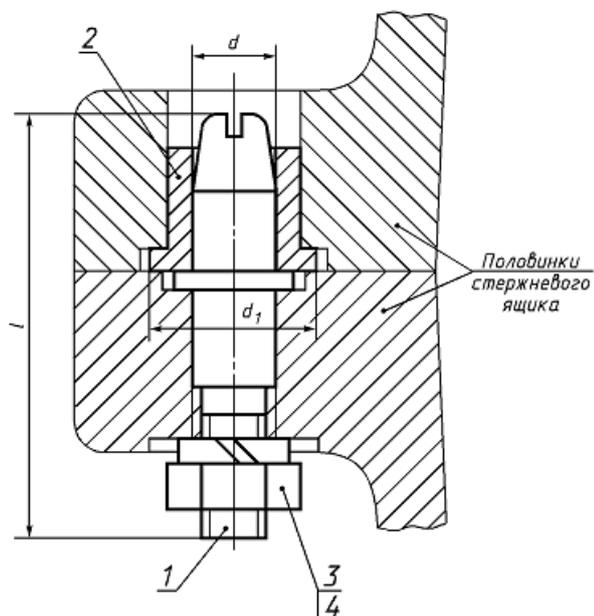
Рис. 3.40. Конструкция облегченных соединений штырями
