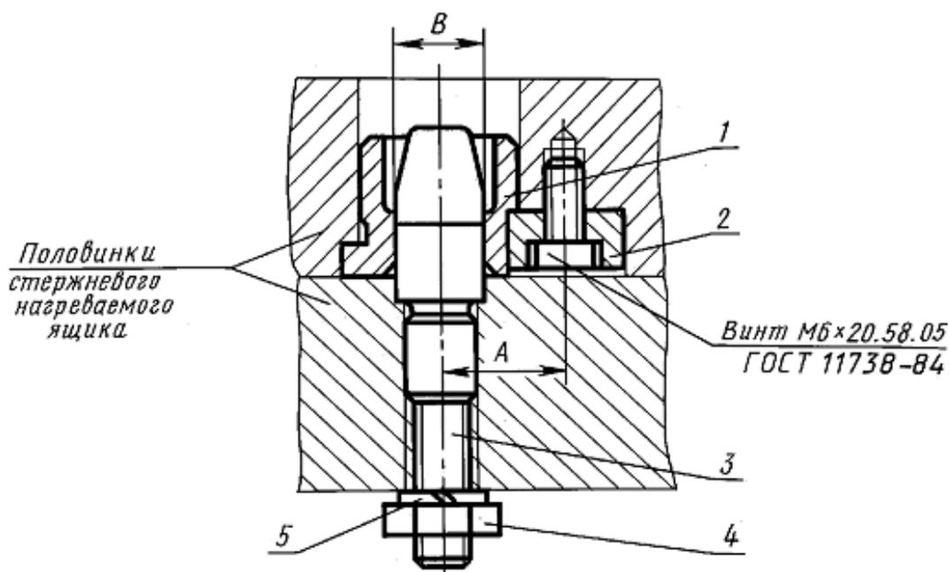
Рис.3.43. Центрирующее соединение с фиксацией направляющей втулки зажимом
