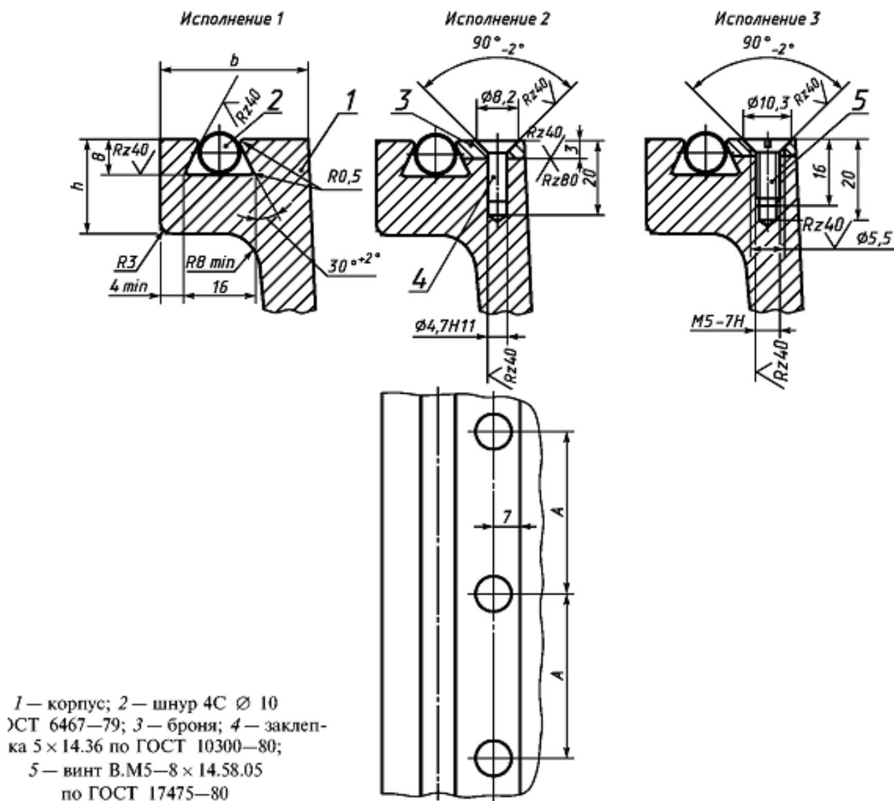
Рис.3.71. Конструкции паза под резиновый уплотнитель:
