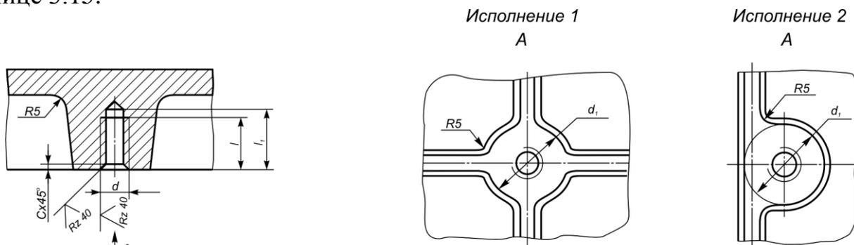
Рис.3.19. Приливы для крепления стержневых ящиков к промежуточной плите
