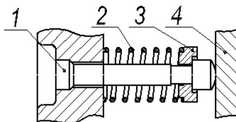
Рис.3.25. Независимая система выталкивания:
