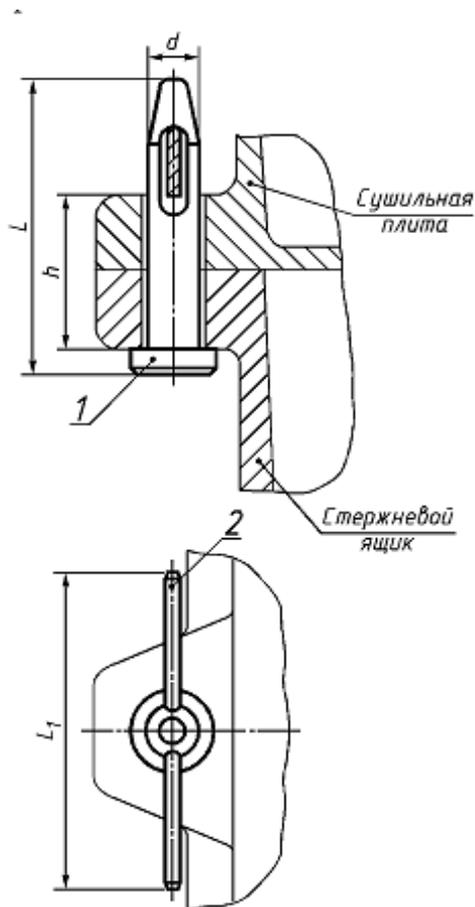
Рис. 3.53. Крепление стержневого ящика с сушильной плитой или его отдельными частями штырем с клином
