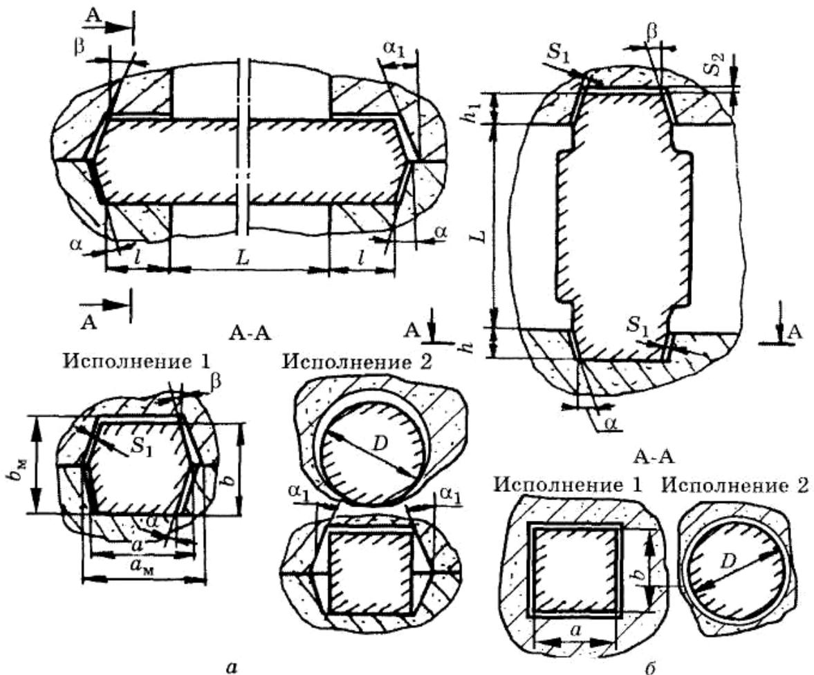
Рис.1.3. Стержневые знаки: *а* – горизонтальные; *б* – вертикальные
