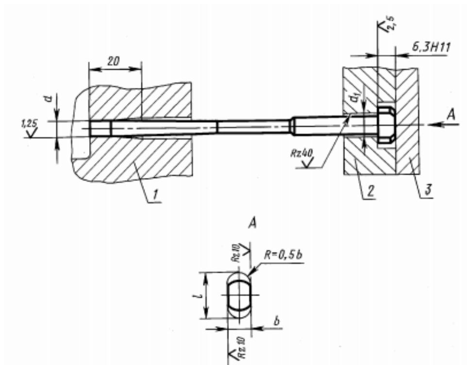
Рис.3.26. Примеры установки выталкивателей:
