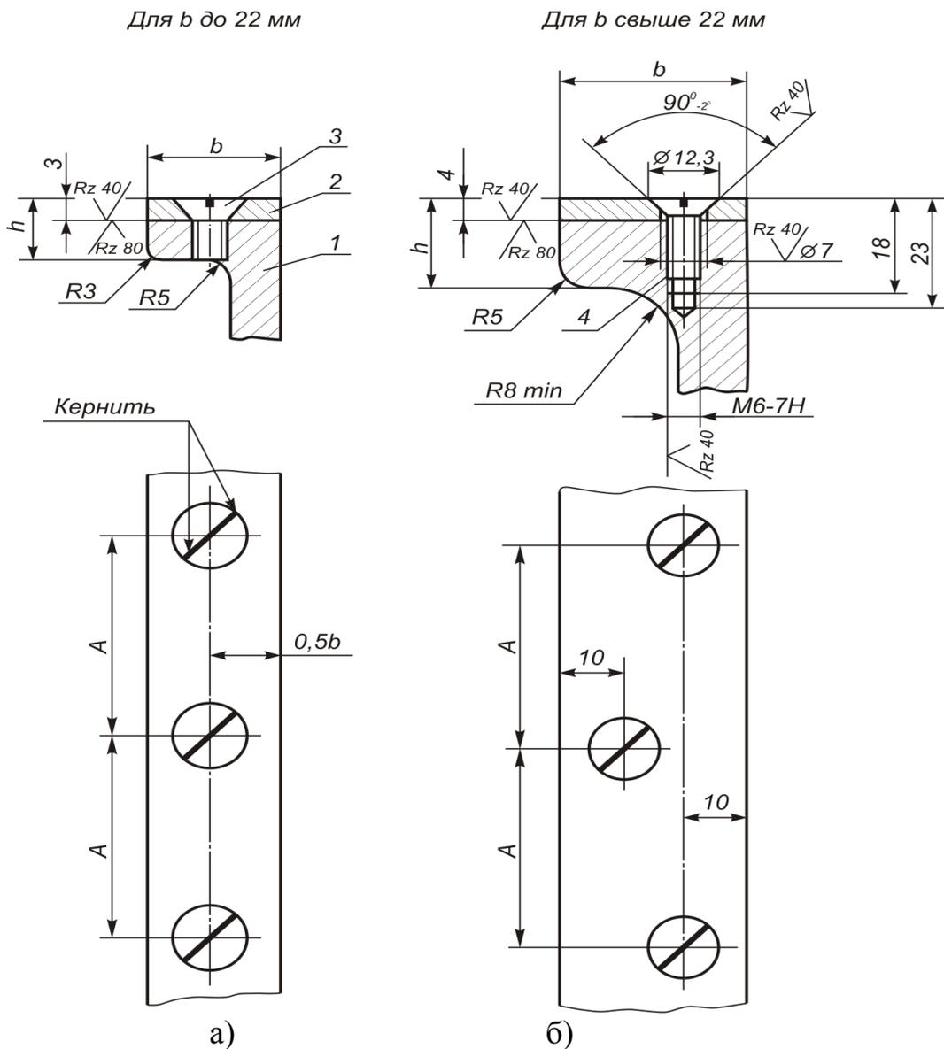
Рис.3.6. Борты алюминиевых стержневых ящиков:
