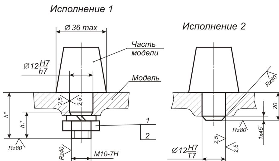
Рис. 2.15. Примеры крепления знаковых частей на моделях отливки
