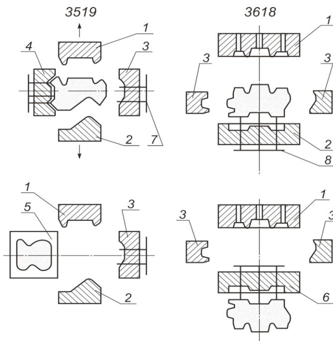
Рис.3.23. Конструктивные схемы стержневых ящиков со сложным разъемом:
