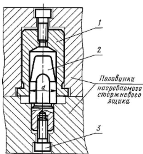
Рис. 3.41. Конструкция центрирующего соединения с винтовым креплением
