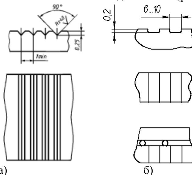
Рис.3.56. Вентиляционные каналы стержневых ящиков и вентиляционных плит:
