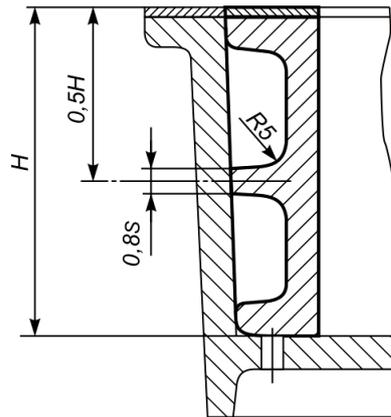
Рис.3.11. Конструкции высоких вкладышей
