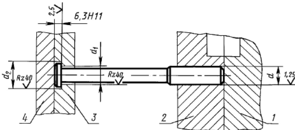
Рис.3.32. Пример установки колонки возврата:
