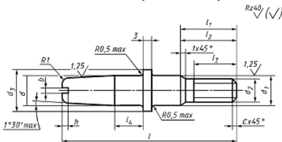
Рис.3.36. Конструкция центрирующих штырей с резьбовым хвостовиком
