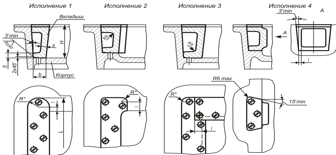
Рис.3.8. Примеры крепления вкладышей в корпусе стержневого ящика
