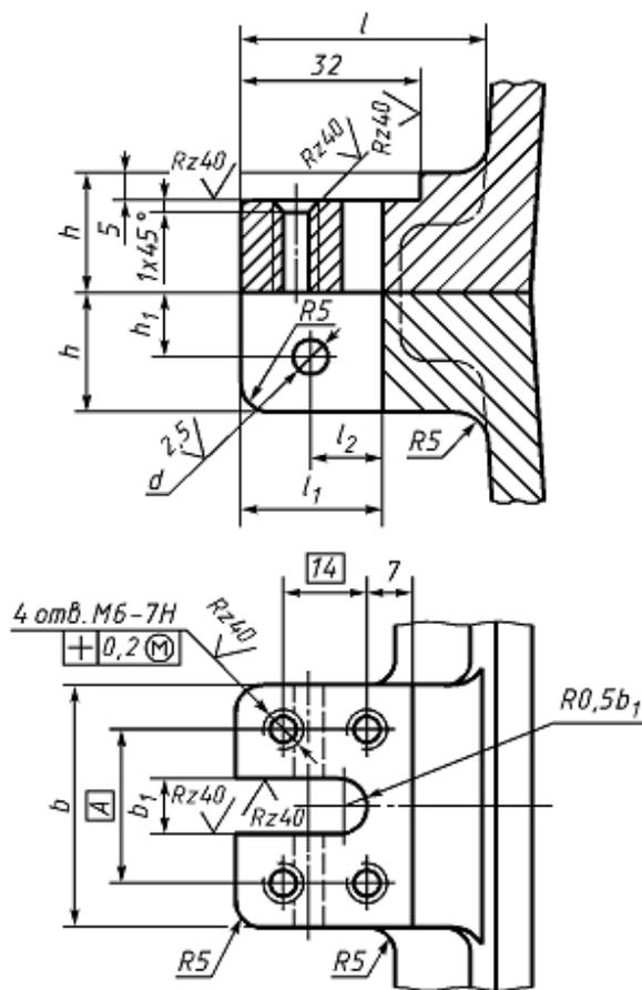
Рис. 3.50. Конструкция и размеры приливов для установки креплений
