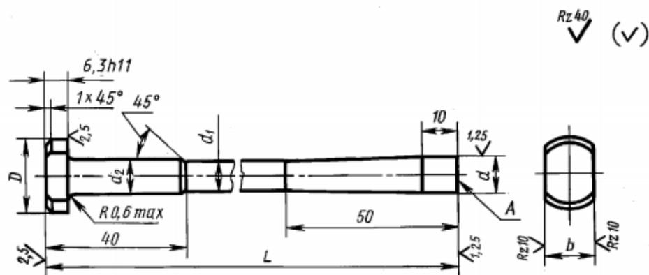
Рис. 3.27. Конструкция стационарного выталкивателя
