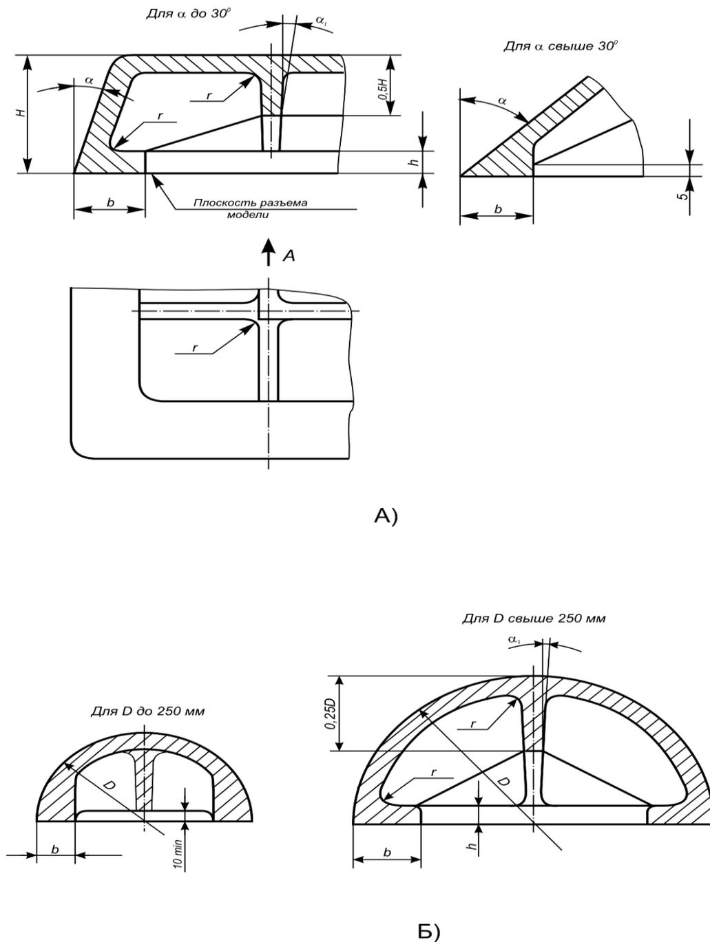
Рис.2.5. Борты и ребра прямоугольных, круглых и цилиндрических моделей
