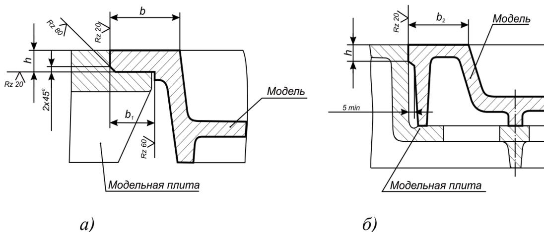
Рис. 2.3 Крепление моделей-фальшивок к модельным плитам:
