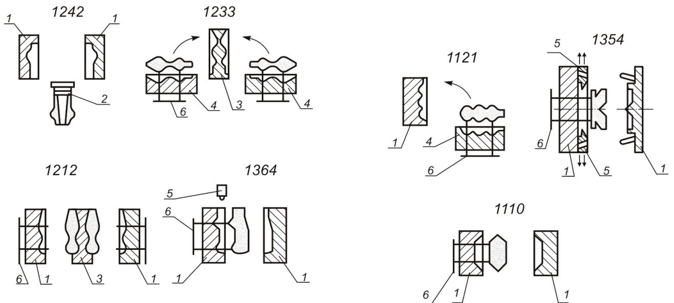
Рис.3.21. Конструктивные схемы стержневых ящиков с надувом параллельно плоскости разреза:
