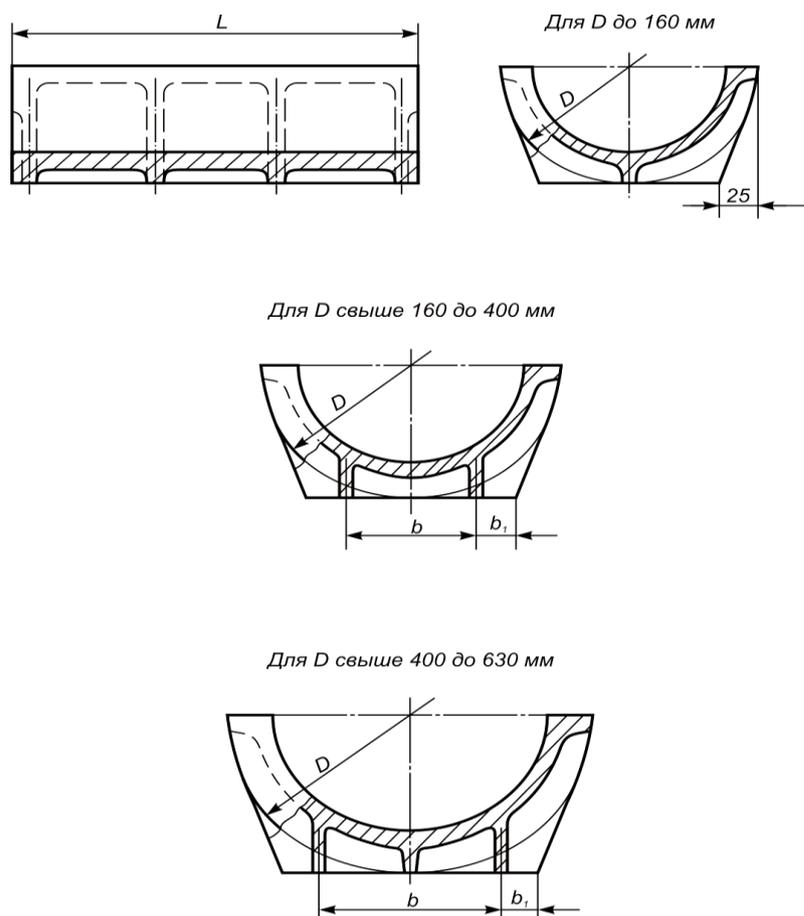
Рис. 3.4. Ребра цилиндрических стержневых ящиков
