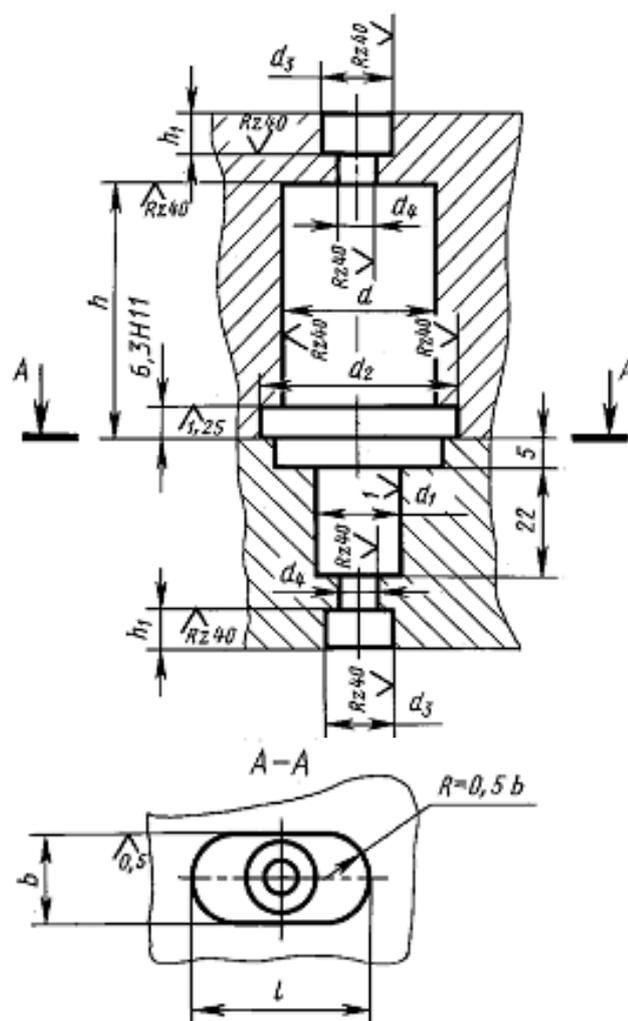
Рис.3.42. Конструкция гнезд для установки центрирующих соединений с винтовым креплением
