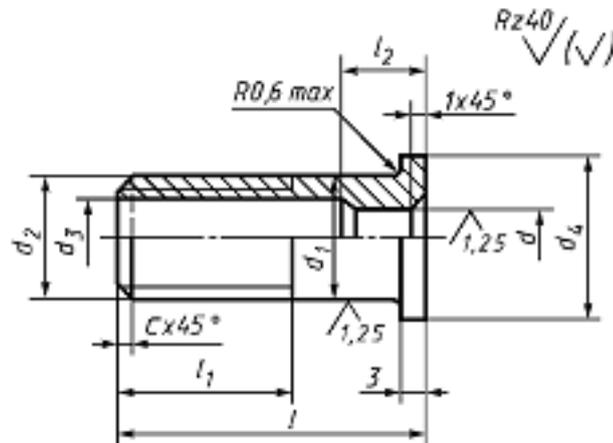
Рис.3.33. Конструкция центрирующих втулок с резьбовым хвостовиком
