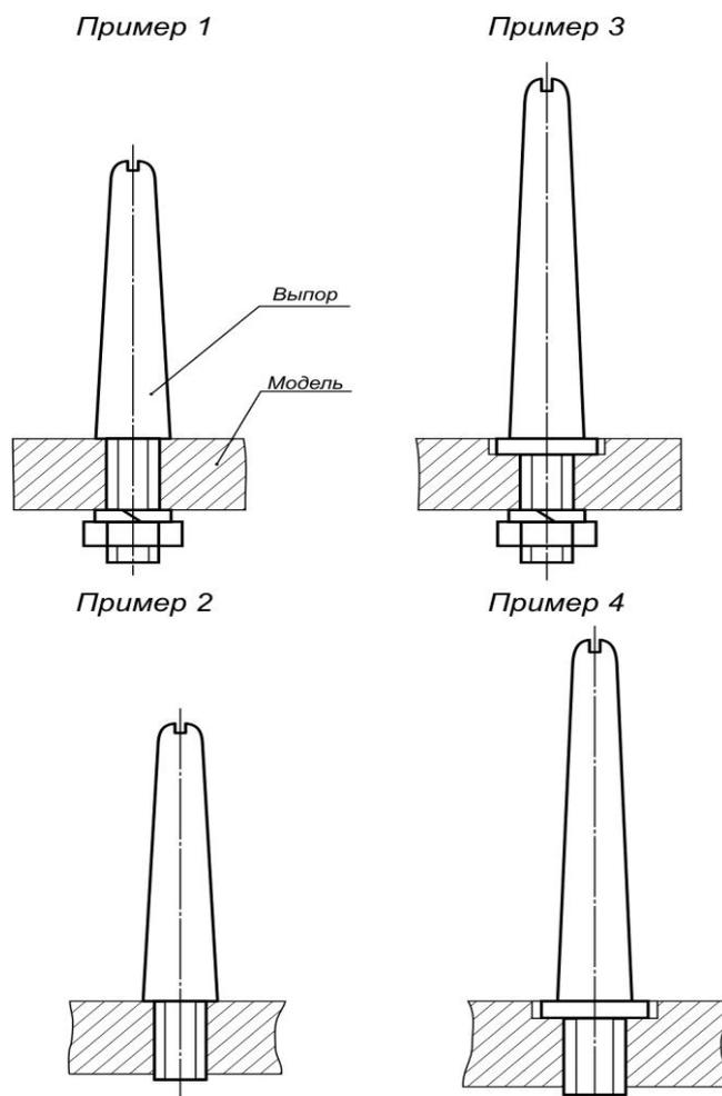
Рис. 2.13. Примеры установки газоотводных выпоров на моделях отливки
