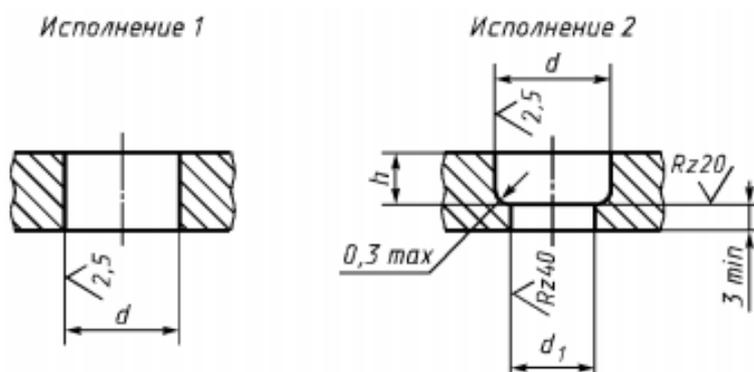
Рис.3.59. Отверстия для установки вент
