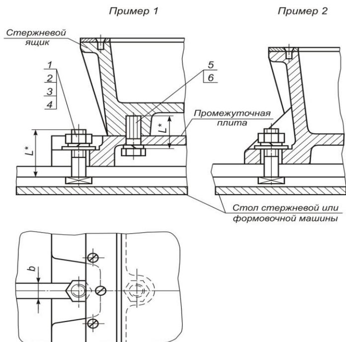
Рис.3.20. Примеры крепления стержневых ящиков
