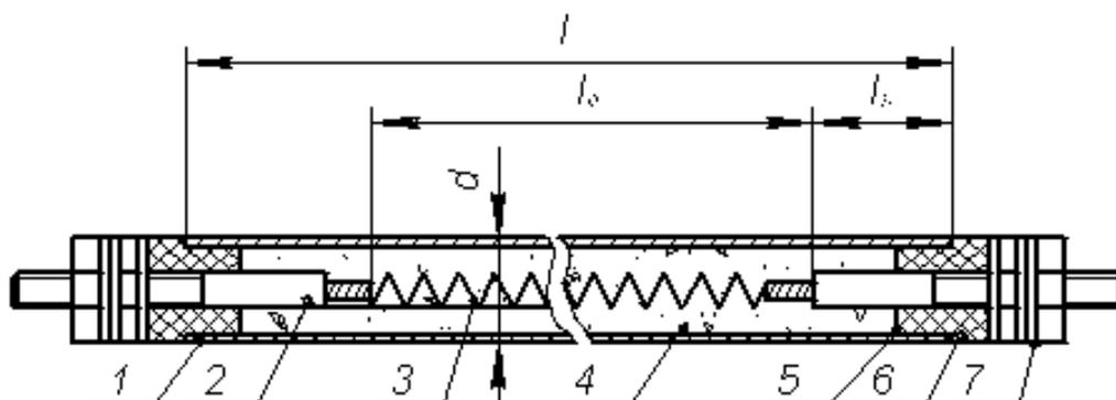
Рис.3.73. Электронагреватель трубчатый:
