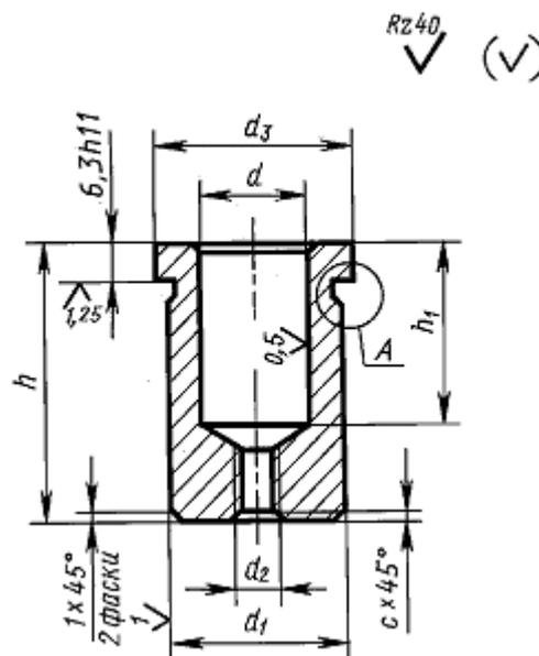
Рис.3.34. Конструкция центрирующих втулок с резьбовым отверстием
