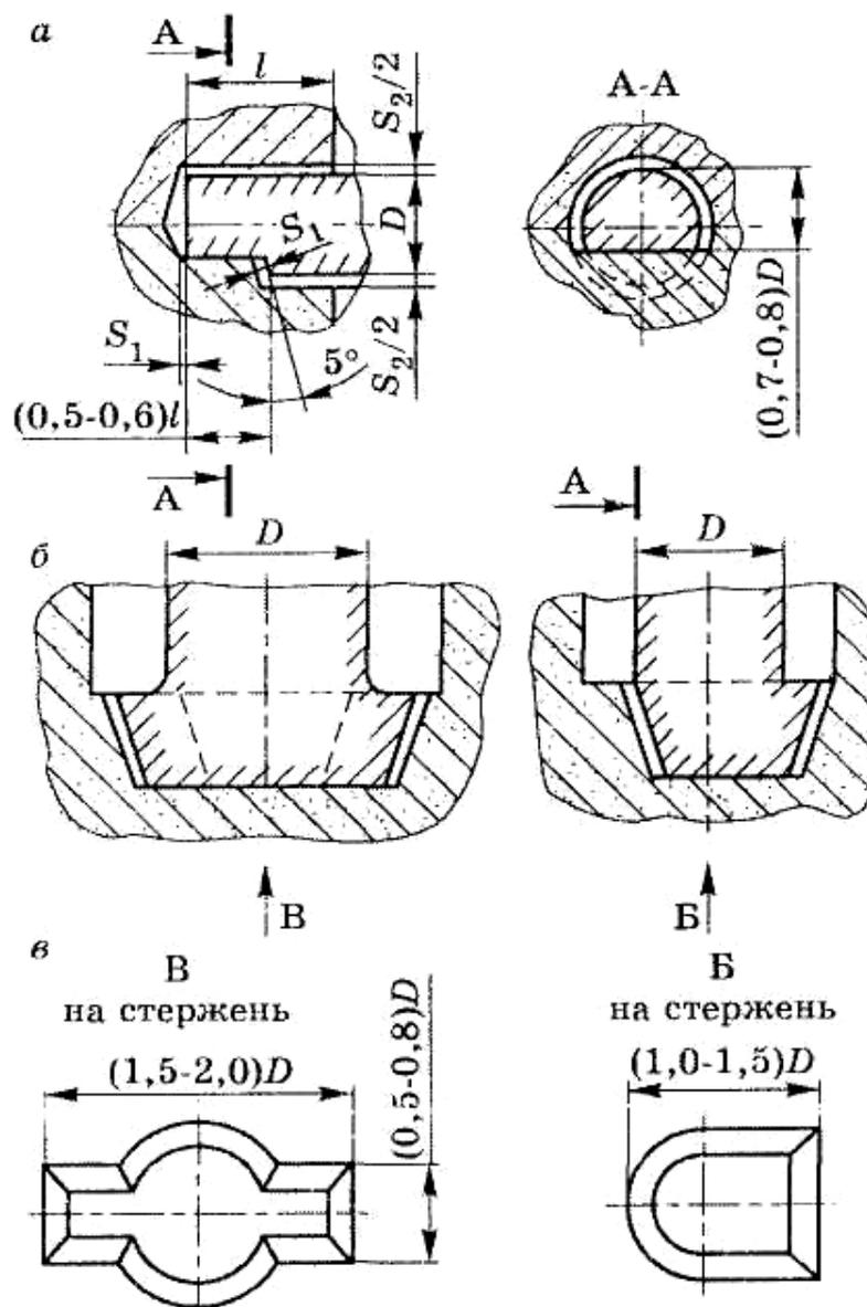
Рис.1.5. Примеры конструктивных исполнений стержневых знаков
