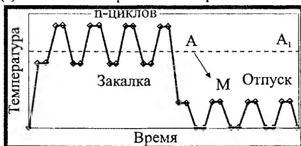
Рисунок 2- Диаграмма УТЦО быстрорежущей стали, включающая термоциклирование выше и ниже критической точки  $A_1$  с закалочным охлаждением на последнем цикле и отпуском
