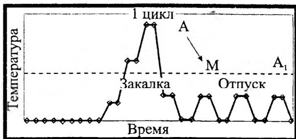
Рисунок 1- Диаграмма традиционной термической обработки быстрорежущей стали
