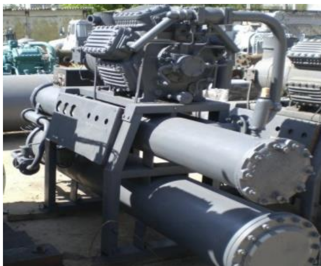
Рисунок 1 – Базовая агрегатированная хладоновая холодильная машина марки МКТ-80-2-0
