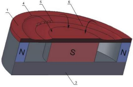
1 – катод-мишень; 2 – анод; 3 – магнитная система; 4 – силовая линия магнитного поля; 5 – траектория движения электронов;
