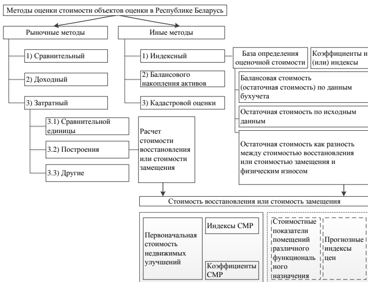
Рисунок 2 – Порядок применения стоимостных показателей строительства помещений различного функционального назначения в оценке недвижимости
